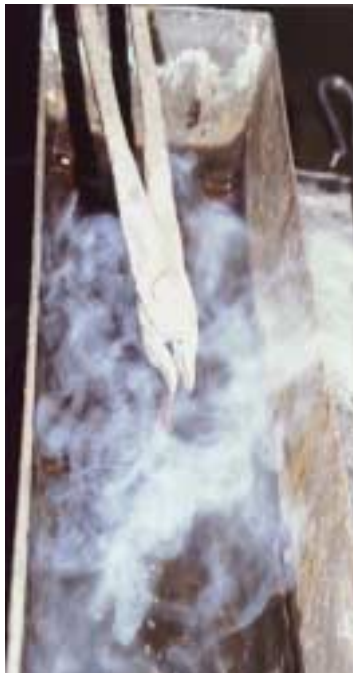
Fig. 16. Eldstålen härdades vid 800-850°C, en lagom härdningstemperatur för eldstål.
